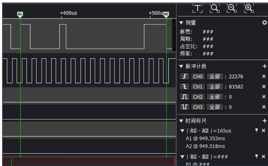
A1、A2 分别显示时间标尺 A1 和 A2 所在位置的时刻值；|A1-A2|显示的是两标尺间的时间差；上升沿显示鼠标所在通道的 A1 和 A2 之间的上升沿个数。
