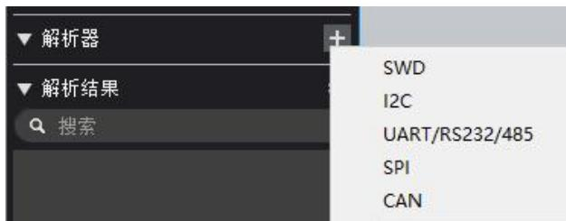
点击其右端的 按钮，在弹出的菜单中选择“SPI”，此时会弹出协议设置对话框，都使用默认设置，直接点击“确定”即可，至此我们就已经添加进了一个标准的 SPI 协议解析器。接下来我们点击工具栏上的 按钮，稍等片刻软件就会在通道 0-3 上模拟出标准的 SPI 信号波形，并解析出数据，而其它通道则依旧是模拟的随机方波或脉冲信号。如下图所示：
