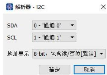
在弹出的对话框中，设置 SDA 为通道 0，SCL 为通道 1，点击“确定”，会自动在通道 0 和通道 1 上显示协议解析器中对应通道的名字，然后软件便会按照标准的 I2C 协议对通道 0 和 1 进行解析，解析完成后将在波形显示窗口的 I2C-SDA 通道上显示解析出的数据，同时也会在右侧的“解析结果”窗口中显示解析出的数据，用户可以在此窗口内查找和快速定位某个数据。解析后的数据显示如下图：
