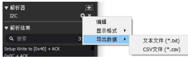
下图分别为 UART、I2C、SPI 协议解析器导出数据的示例，可以看到，在导出数据中包含了时间坐标、数据包序号、解析数据等。
