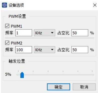
**PWM 设置：**逻辑分析仪自带 2 路 PWM 波形发生器，可以输出频率与占空比可调的方波信号。当软件连接到支持 PWM 输出的设备时，设备上电时默认为：PWM1 输出频率 1KHz 占空比 50% 的方波，PWM2 输出频率 100KHz 占空比 50% 的方波。
