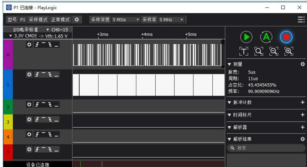
由图可见，当前的时间轴比例太大，导致有效信号波形被压缩在很小的一段内，根本看不清楚。此时，可以将鼠标移动到有效波形的位置处，然后点击鼠标左键，即可放大波形。局部放大后的效果如下图。
