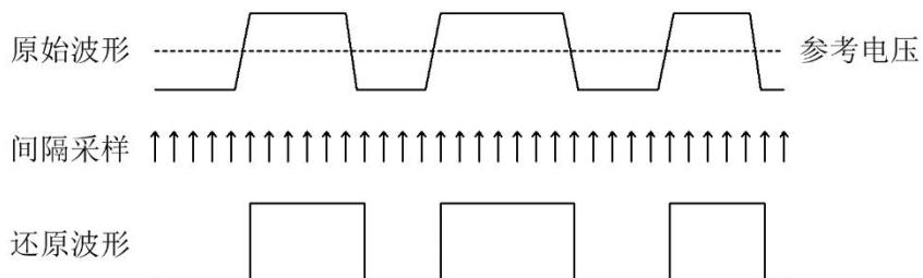
根据硬件设计上的差异，逻辑分析仪大致可分为独立式（或称单机型）或需结合电脑使用的虚拟式。芯驿电子科技（上海）有限公司推出的逻辑分析仪产品均属于虚拟式逻辑分析仪。设备硬件根据设定的条件采集被测信号，然后将采样数据上传到电脑端的软件 Play Logic。软件将采集到的原始数据还原为数字波形显示到电脑屏幕上，并可以根据所支持的标准协议对数据进行解码，以及其它一些分析及测量功能。
