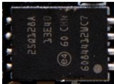
图 1-5-2 QSPI FLASH 部分实物图
