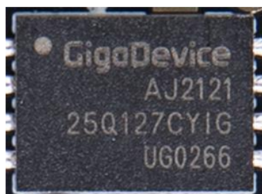
图 2-5-2 QSPI FLASH 部分实物图
